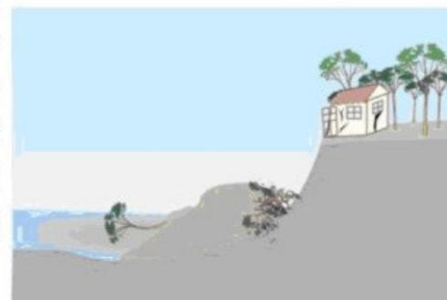
2. 当新址位于沟边时，应该设置在一定高度的斜坡上。位于岸边时，应注意水位高度，避免洪水掏空斜坡形成滑塌等灾害。同时，应避免直接坐落在沟谷口，以防泥石流灾害；
