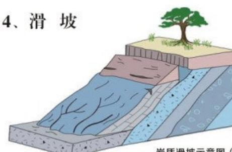
岩质滑坡示意图(滑坡体沿岩层面滑动)
